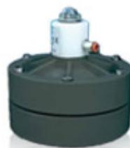
Автоматические мембранные гасители пульсаций EQUAFLUX – устройства, работающие от сжатого воздуха. Демпферы устанавливаются на нагнетательной линии мембранных пневматических насосов с целью уменьшения пульсаций жидкости, могут использоваться с жидкостями с вязкостью до 50000 сПз (при 20°С), и также с жидкостями, которые содержат твердые взвешенные частицы значительных размеров.
