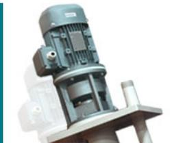
Высокопроизводительные вертикальные полупогружные центробежные насосы серии IM, предназначенные для стационарной установки с погружным типом монтажа, изготовлены из полимера, приводятся в действие электродвигателем (макс. 3000 об/мин) с прямым приводом и служат для быстрого перекачивания и/или слива жидкостей с производительностью от 6 м<sup>3</sup>/ч до 75 м<sup>3</sup>/ч.
