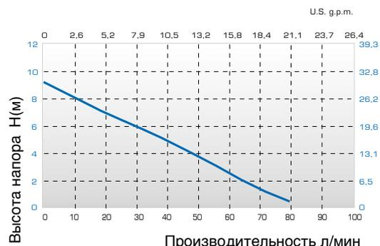
\*Кривые и значения эксплуатационных показателей относятся к насосам со свободным нагнетающим отверстием, с водой при 20°C.
