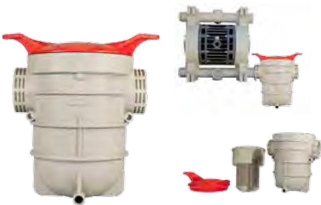
Благодаря общему проходному пространству корзины эти фильтры, в частности, предназначены для установки на всасывающем канале насосов, обеспечивая защиту от взвешенных твердых частиц, волокон, водорослей и инородных тел, не вызывая при этом чрезмерных потерь напора. Фильтр выполнен из полипропилена, не содержит металлических частей, предусмотрена возможность легкого доступа и удаления корзины, рабочее давление 1 бар.
